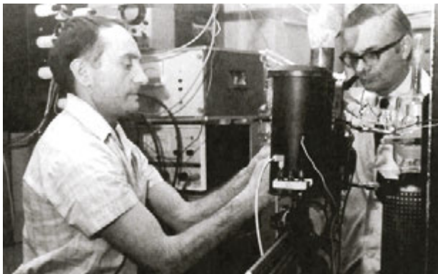
► Lipsk, profesor Tadeusz Radoń (z lewej) wraz z profesorem Christianem Kleintem (z prawej) przygotowują się do skierowania strumienia światła z łuku rtęciowego na ostrze znajdujące się w szklanym mikroskopie polowym w warunkach ultrawysokiej próżni Fot. archiwum prywatne
